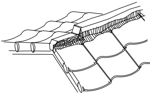
先端をきれいに折りたたみ、小口を塞ぐようになじませながら、両端の接着部分が棟巴からはみ出ないように両側50mm程度貼り付けてください。
