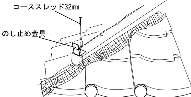
先端部は100mm程度の幅に縮めて瓦面にしっかり押さえつけて留める。
