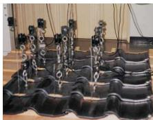
石州瓦メーカーでは耐風性能を測る試験を数多く実施し、建築基準法が定める耐風性能基準を十分に満たしていることを実証しています。
